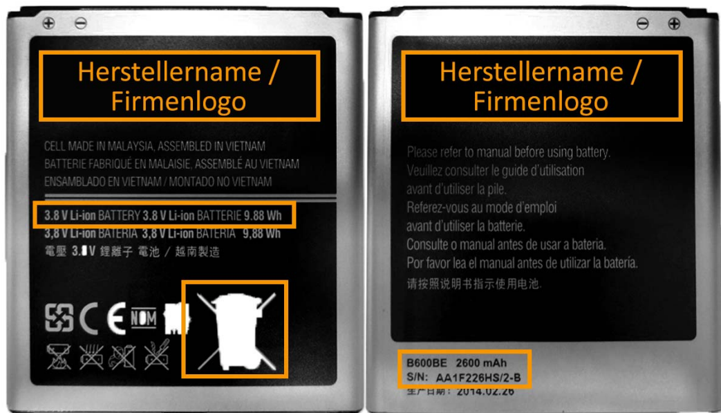
Abbildung 11: Bild der Angaben auf einem Lithium-Akkumulator eines namhaften Smartphone-Herstellers
